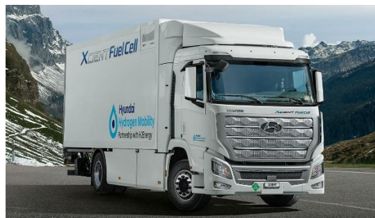
Abbildung 50: Hyundai Xcient Fuel Cell: erster Serien-Wasserstoff-Brennstoffzellen-Schwerlast-Lkw
