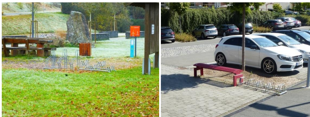
Abbildung 37: Prüm und Speicher – Anlehnbügel mit Schräge und Anlehnbügel mit Kanten
