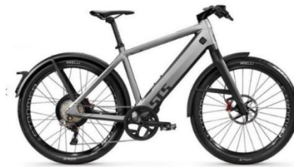
Abbildung 41: S-Pedelec mit Unterstützung bis 45 km/h
