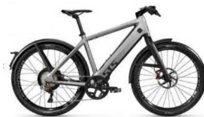
Abbildung 41: S-Pedelec mit Unterstützung bis 45 km/h
