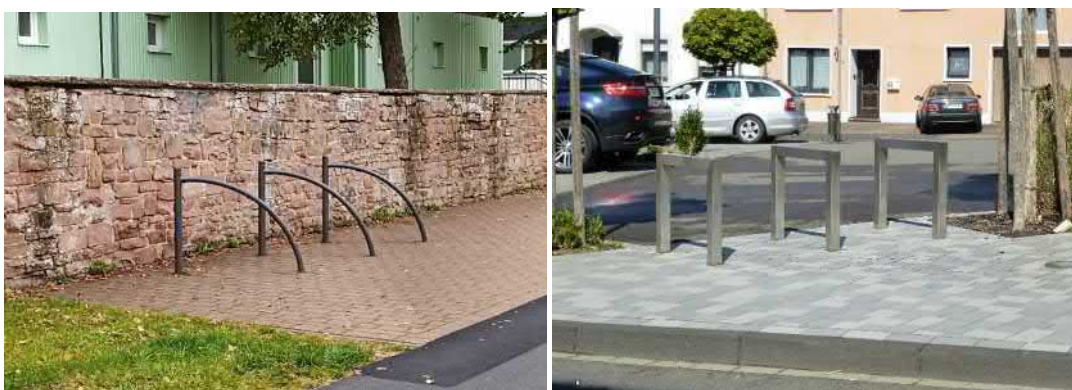
Abbildung 37: Prüm und Speicher – Anlehnbügel mit Schräge und Anlehnbügel mit Kanten
