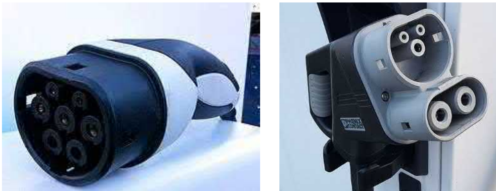
Abbildung 104: Typ-2-Stecker für das Laden mit Wechselstrom (links), CCS Gleichstrom (rechts)
